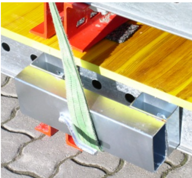
Sicherung der Ladehilfe mit zwei Flanschmuttern
